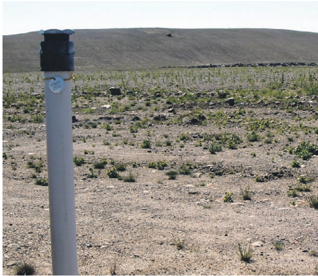
Pohjavesiputki kaivosjätteen loppusijoitusalueella.
